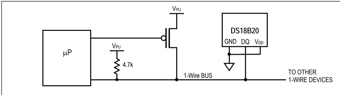
**Figure 5. Powering the DS18B20 with an External Supply**
