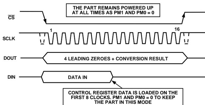
Figure 13. Normal-Mode Operation
